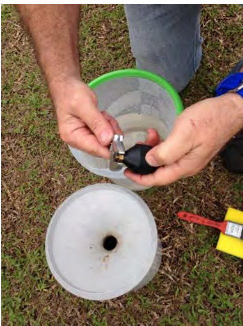
Limpeza do sifão do pluviômetro
