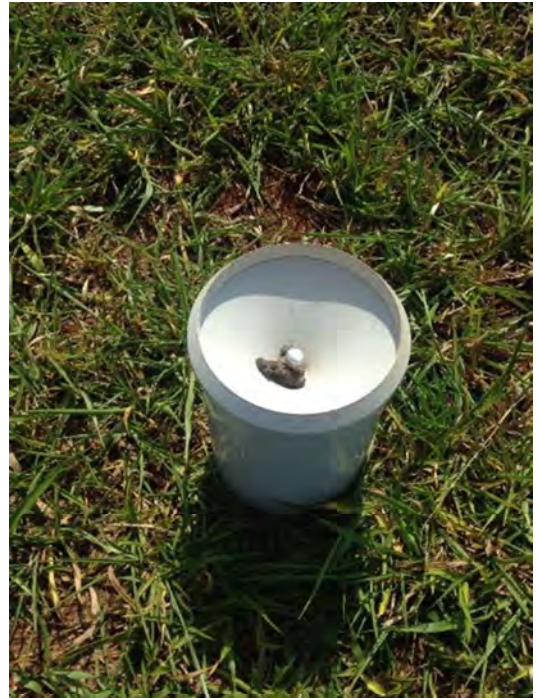
Pluviômetro com sujeira
