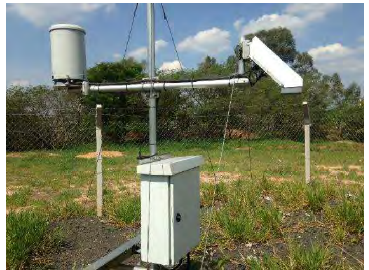
Vista geral da estação com sensor EFM e pluviômetro (após limpeza)
