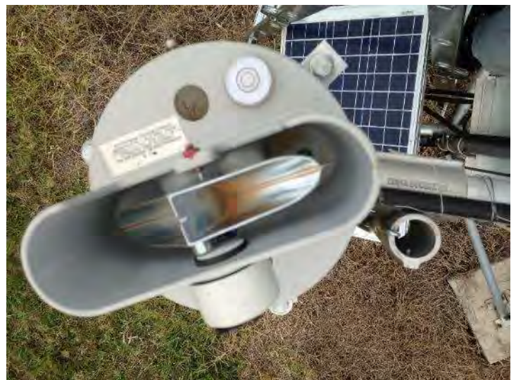
Pluviômetro com sujeira na balança (poeira)
