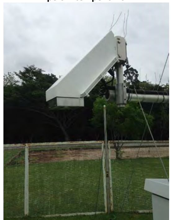
Detalhe do sensor EFM (após limpeza)
