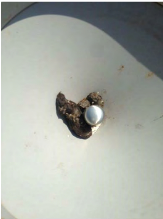
Pluviômetro com sujeira (detalhe)
