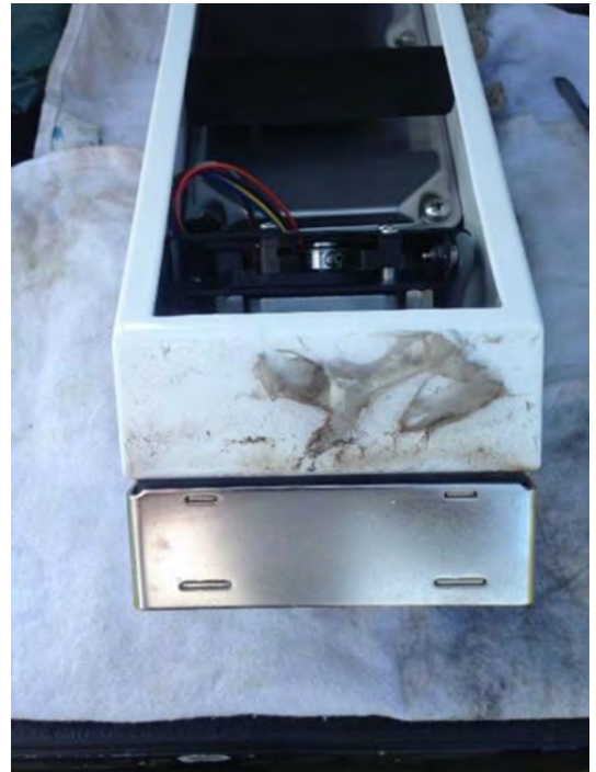
Vista do sensor EFM aberto mostrando sujeira
