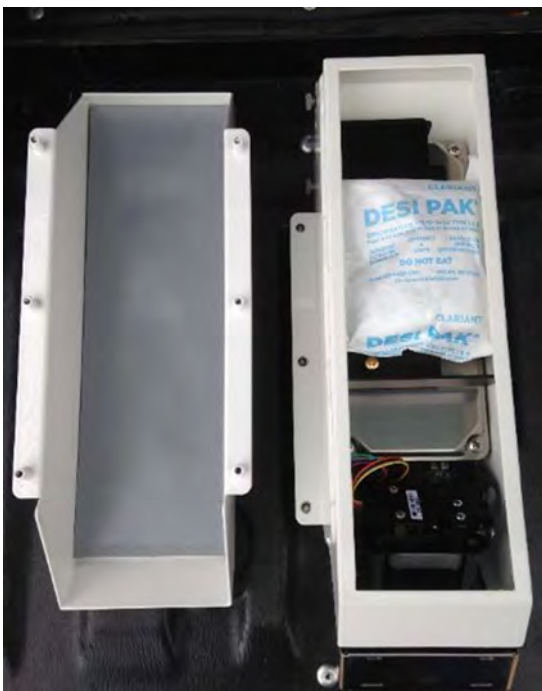
Sensor EFM aberto após limpeza mostrando o dessecante de sílica-gel
