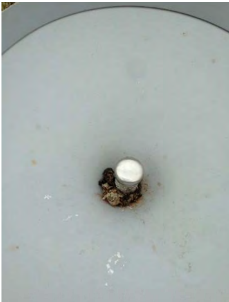
Pluviômetro com sujeira no funil captador (insetos)
